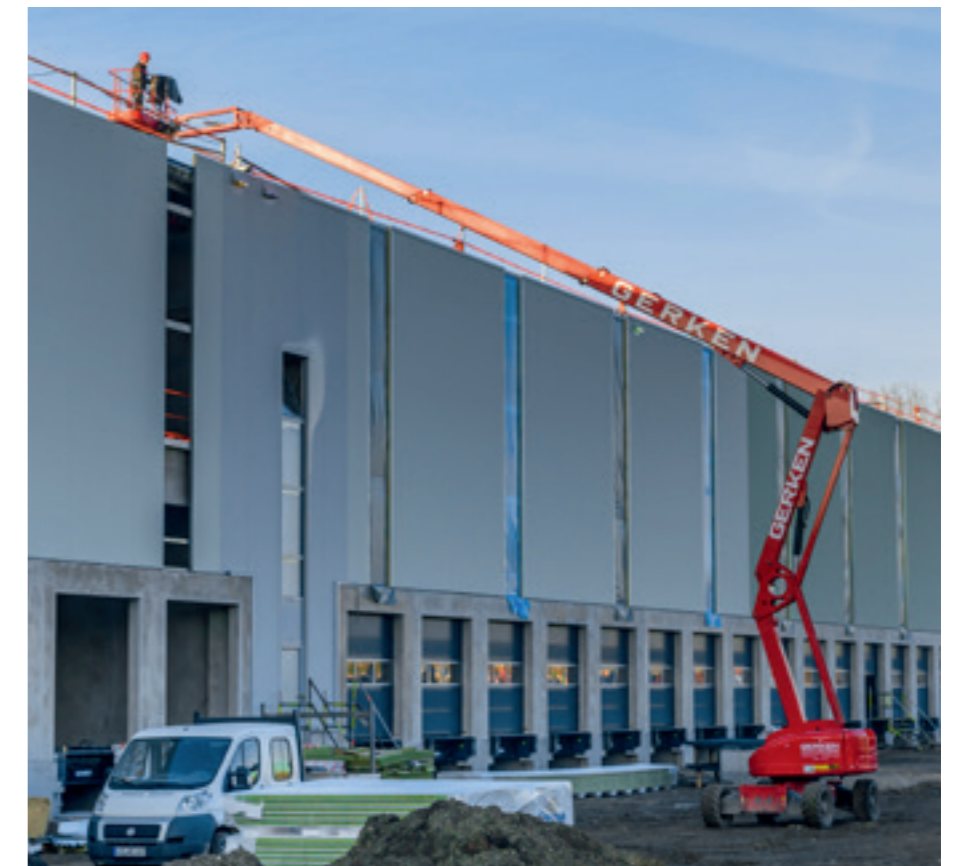
▼ Bis zu 19,36 Meter seitliche Reichweite erreicht die Gelenkteleskop-Arbeitsbühne GG 280-25 AWkPHR Hybrid. Wahlweise mit Diesel oder emissionsfreiem Batterieantrieb.
